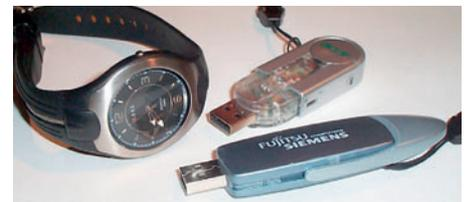
Drei verschiedene USB-Sticks. Bei der Uhr ist links vom Zifferblatt das ins Armband integrierte helle Anschlusskabel erkennbar.
