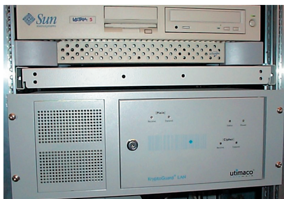
Bild 1: Die Max-Planck-Gesellschaft nutzt für ihr VPN CryptoGuard VPN 3000 (Bild: unten im 19"-Rack); zum Entscheidungszeitpunkt von Utimaco vertrieben, werden die Boxen heute von Compumatica weiterentwickelt.
