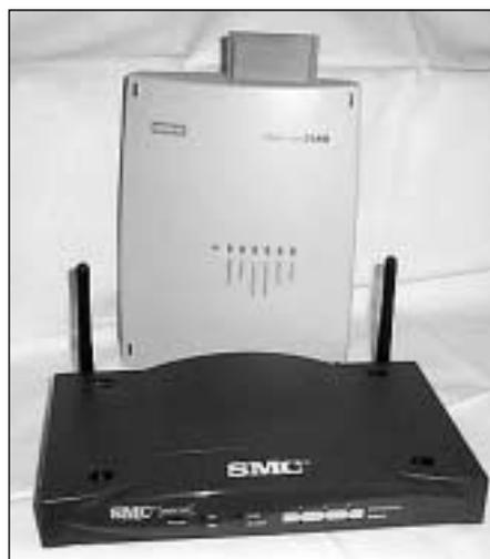
Abbildung 2: Access-Points der Hersteller Siemens (hinten) und SMC (vorn). Bei dem hinteren Access-Point von Siemens ist deutlich die eingesteckte PCMCIA Karte zu erkennen.
